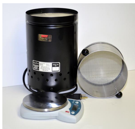
Tørstofmåler med elektronisk vægt
